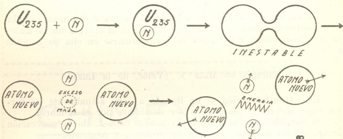
El exceso de masa se transforma en energía de acuerdo a la ecuación de Einstein y se manifiesta como energía cinética de las partículas formadas en la fisión y como energía radiante. La energía cinética de las partículas que salen disparadas, se transforma en calor, cuando dichas partículas chocan contra otras.
