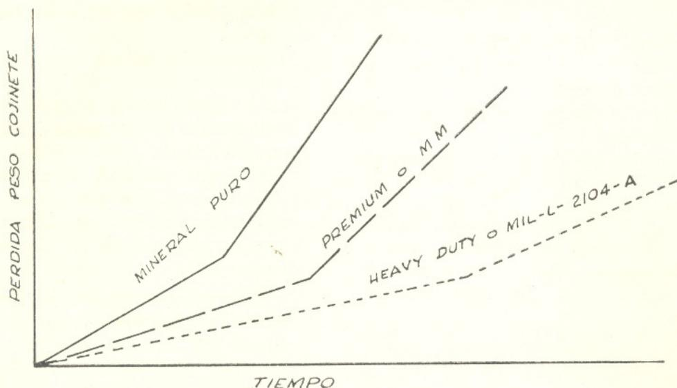
ensayo en la misma muñequilla del cigüeñal correspondiente al cilindro N° 5. El centro de Investigaciones de Thornton no cree que la reproducibilidad sea afectada por la posición de los cojinetes. En función de ello el mencionado centro determina la curva de pérdida de peso de los cojinetes en función del tiempo (desmontan cada 6 horas los cojinetes de Cu-Pb). Las condiciones de marcha y del combustible son las mismas que las del ensayo CRC-L-4.
